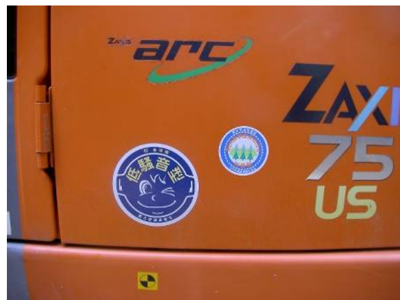
建設機械は低騒音型、排出ガス対策型。このステッカーが目印です。
